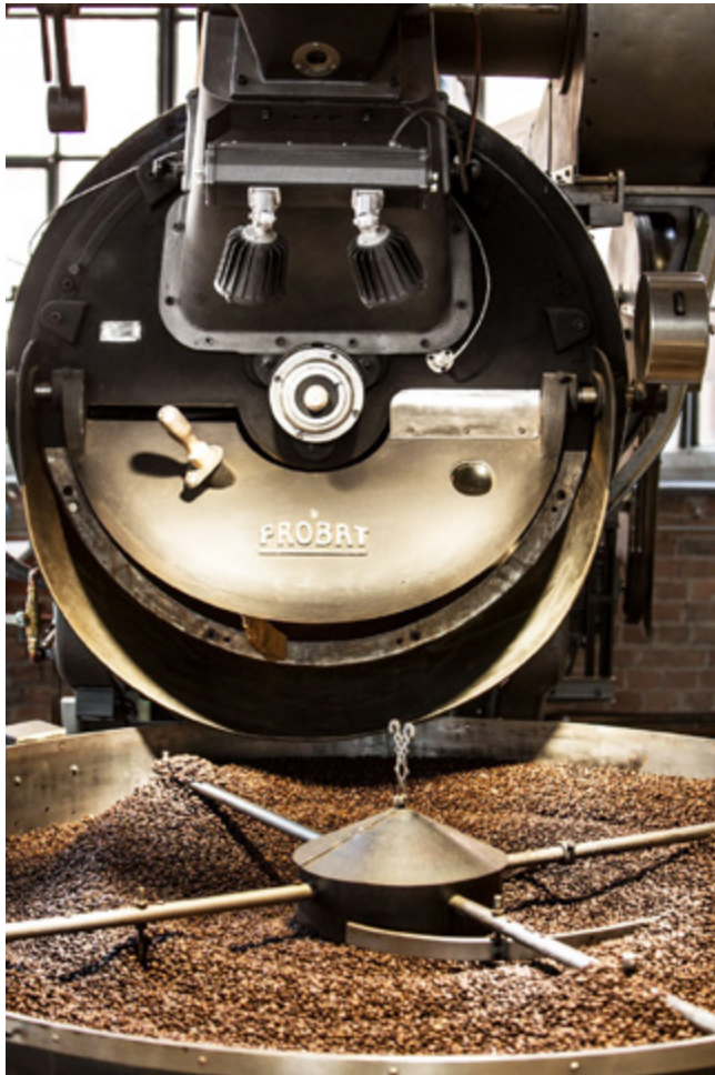
Die frisch gerösteten Bohnen werden aus der Rösttrommel in das Kühsieb gelassen.
